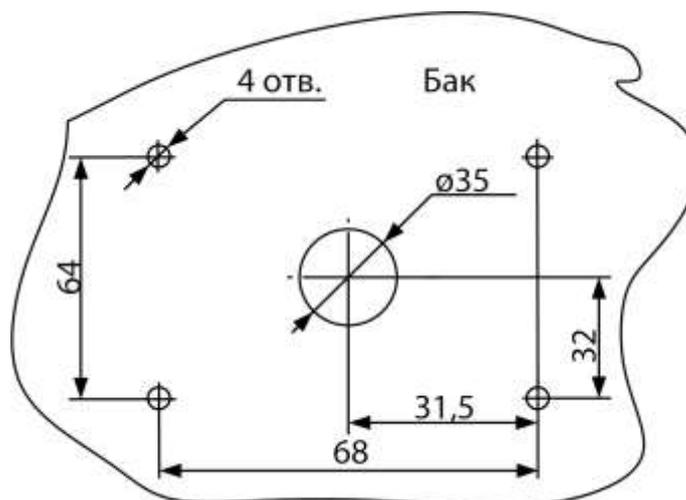
Диаметр крепежных отверстий выбирается в зависимости от материала бака:
