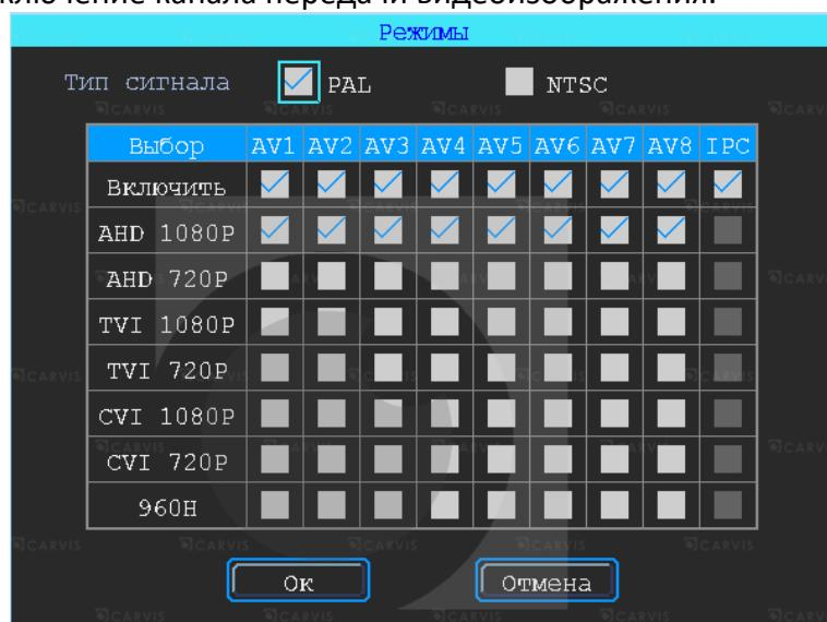
Видеорегистратор работает с AHD, TVI, CVI, IPC, разрешения 720P и 1080P, а также с аналоговыми камерами (960H). Для выбора нужной настройки, нужно поставить «Галку» в соответствующую строку. Переключение показанальное. Настройка регистратора зависит от типа используемых камер.
