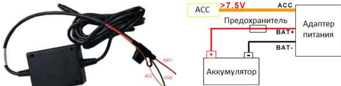
Примечание: при тестировании устройства, подключите оба провода – красный и оранжевый к положительному полюсу источника питания, в противном случае устройство не включится.
