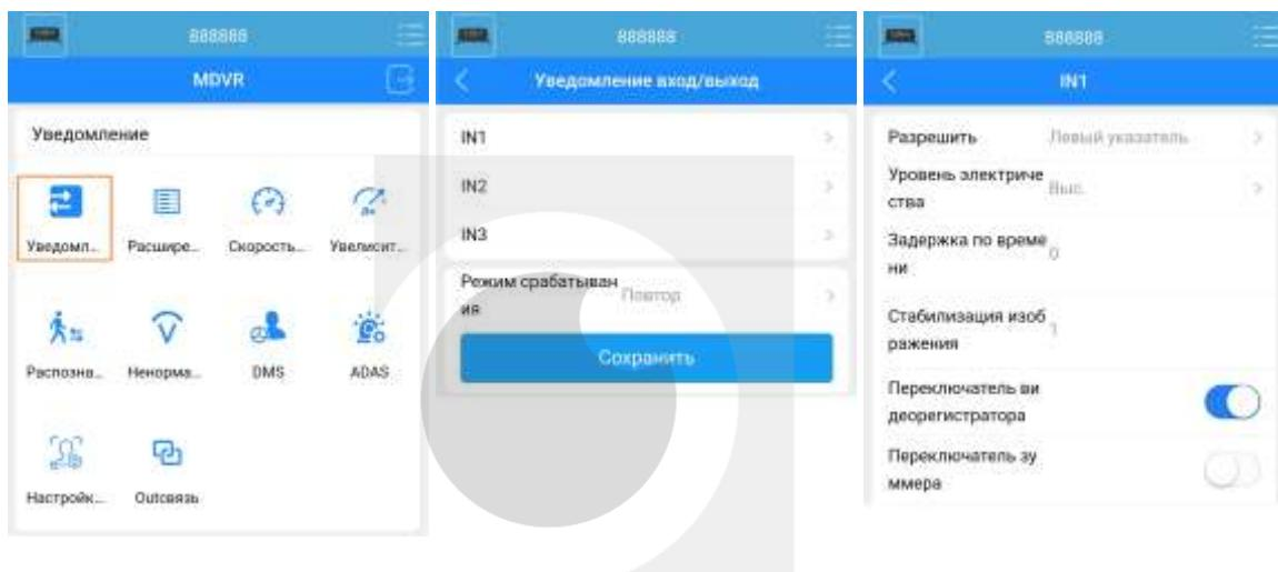
Камера ADAS поддерживает функции обнаружения 4-х тревог: опасность столкновения, съезд с полосы движения, обнаружение пешеходов и опасное сближение. Любую из этих тревог можно отключить или перенастроить.
